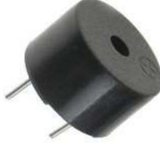
الشكل (8) الطنان الكهربائي
