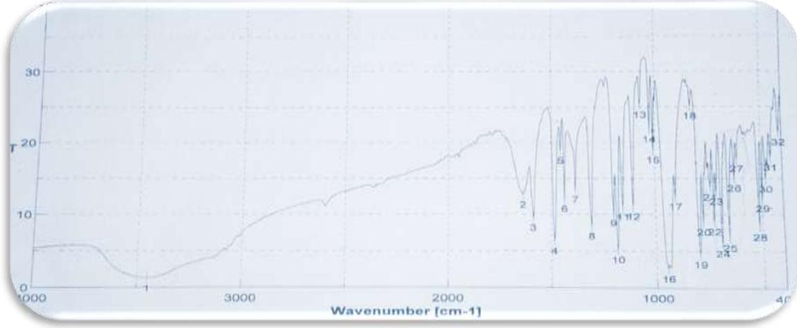
الشكل رقم (5-3) طيف IR للمرتبطة  $(C_6H_5)_2PSNHPS(OC_6H_5)_2$
