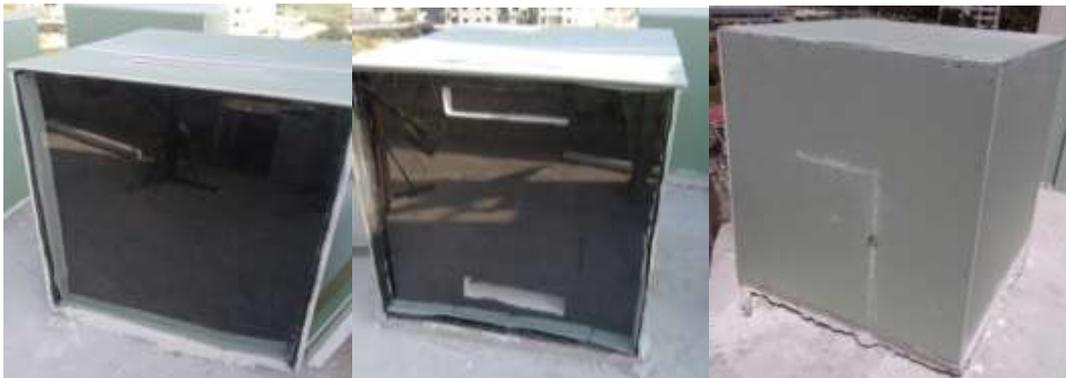
الشكل (3) النماذج المختبرة على أرض الواقع (المرجعي، ذو ترومب التقليدي، ذو ترومب المركب) على الترتيب
