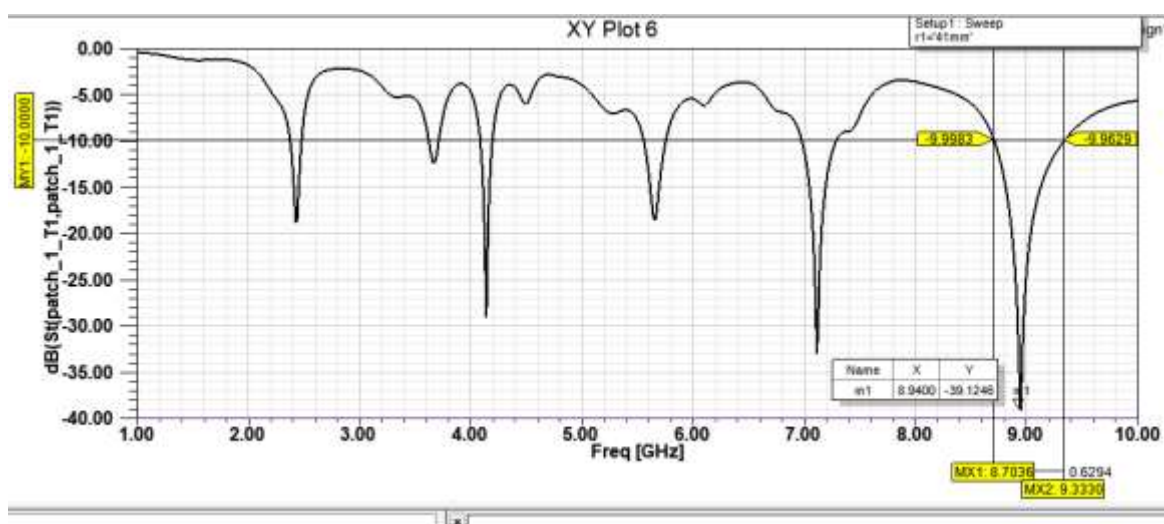
الشكل (13) عرض الحزمة BW لهوائي مصفوفي r_1=41\text{mm} عند التردد f=8.94\text{GHz}
