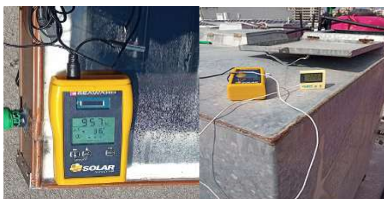
الشكل (2) جهاز قياس شدة الاشعاع الشمسي ومقياس رقمي لدرجة الحرارة
