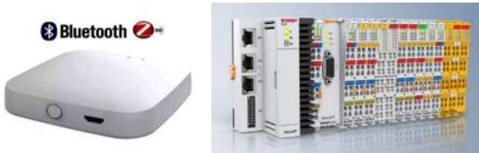
الشكل (8): يميناً : وحدة التحكم مدمجة من طراز BECKHOFF - يساراً: وحدة التحكم لاسلكية من شركة wenzhou nova
