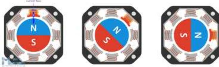
الشكل 5: أقطاب المحرك الكهربائي المستخدم.
