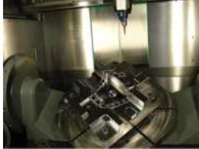
الشكل (2) آلة خماسية المحاور بطاولة دوارة
