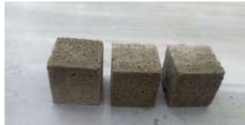
الشكل (2) : نموذج عن عينات البيتون الرغوي بعد الفك
