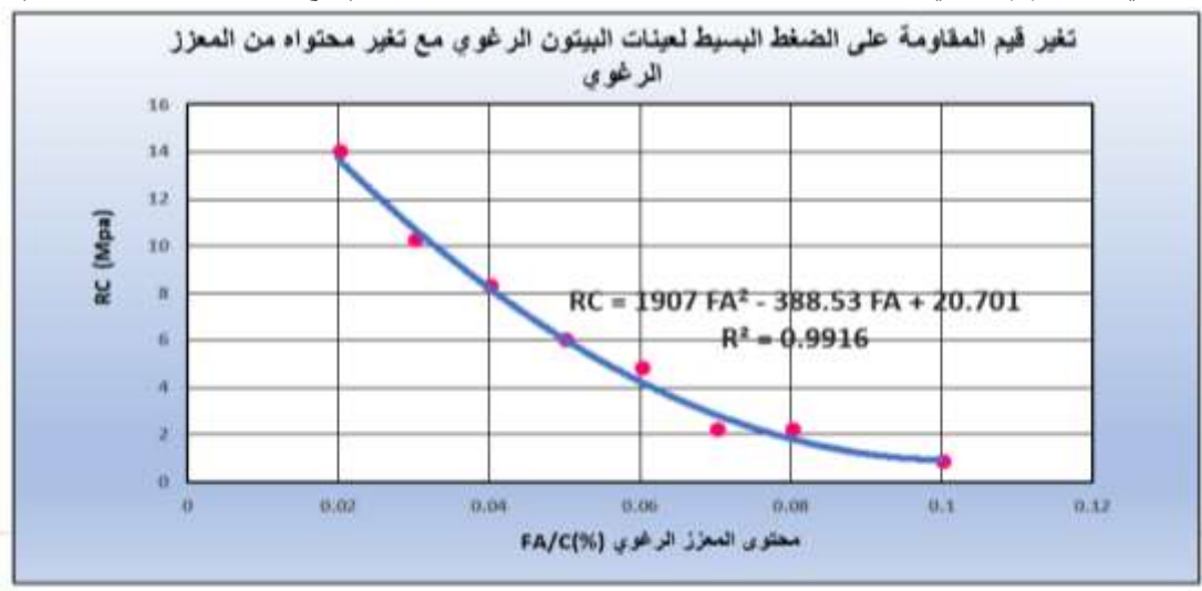
الشكل (4): تغير المقاومة على الضغط البسيط لعينات الببتون الرغوي مع محتوى المعزز الرغوي
