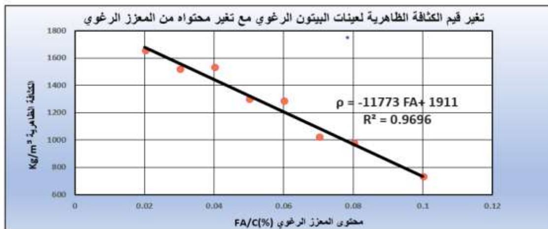
الشكل (3): تغير الكثافة الظاهرية لعينات الببتون الرغوي مع محتوى المعزز الرغوي
