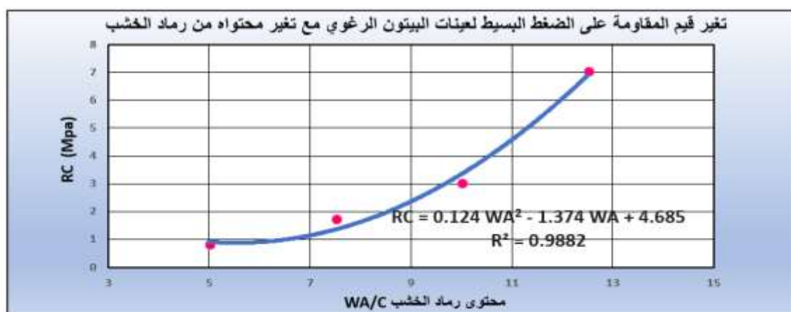
الشكل (8): تغير المقاومة على الضغط البسيط لعينات الببتون الرغوي مع محتوى رماد الخشب
