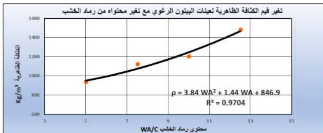
الشكل (7): تغير الكثافة الظاهرية لعينات الببتون الرغوي مع محتوى رماد الخشب
