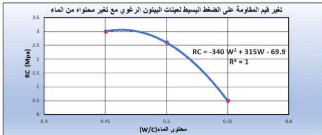
الشكل (6): تغير المقاومة على الضغط البسيط لعينات البيتون الرغوي مع محتوى الماء
