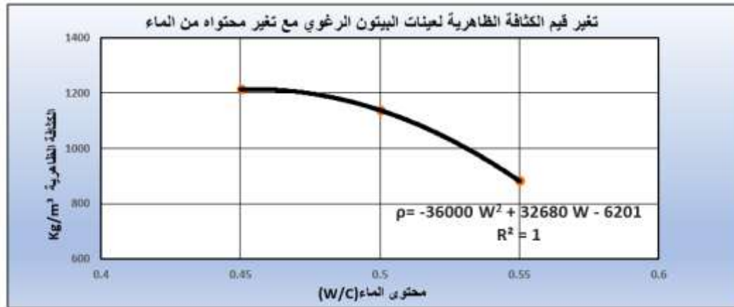
الشكل (5): تغير الكثافة الظاهرية لعينات البيتون الرغوي مع محتوى الماء
