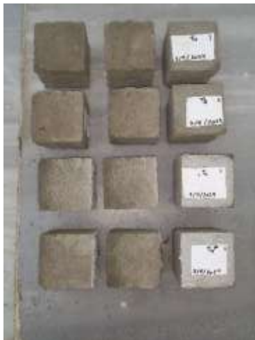
الشكل (2) : نموذج عن عينات البيتون الرغوي بعد الفك
