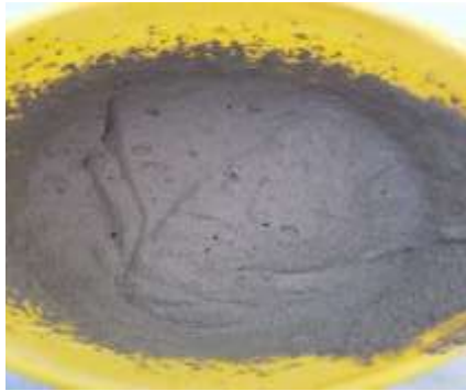
الشكل (1-b) تشكيل خلطة البيتون الرغوي
