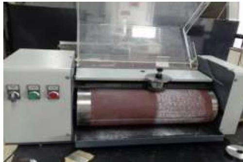
الشكل (7) يمثل جهاز مقاومة الاهتراء (DIN)
